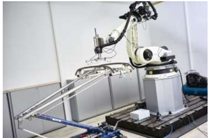
Abb 1. Pantographenprüfstand der Fa. Siemens
