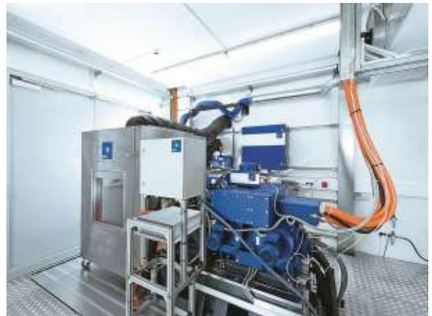
Abb 1. Elektromotor-Prüfstand mit Batterieemulator
