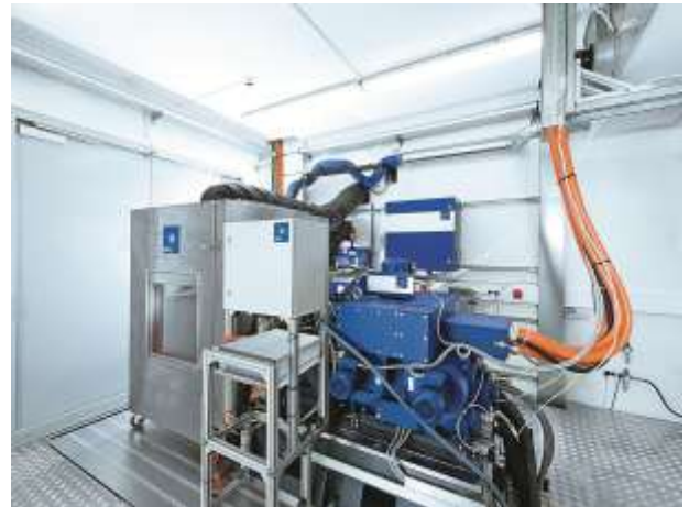
Abb 1. Elektromotor-Prüfstand mit Batterieemulator
